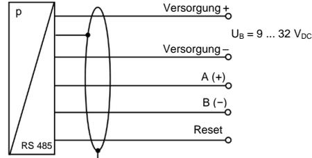
**HINWEIS** - Bei Relativgeräten enthält das Kabel einen Belüftungsschlauch für den Druckausgleich. Führen Sie das Kabelende in einen Bereich oder geeigneten Anschlusskasten, der möglichst trocken und frei von aggressiven Gasen ist, um eine Beschädigung zu vermeiden.
