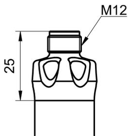
Steckverbindung M12-A, 4-Pin, Edelstahl (mit LED), KingCrown
