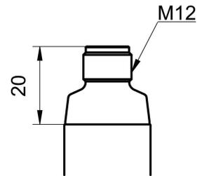
Steckverbindung M12-A, 4-Pin, Edelstahl (ohne LED)
