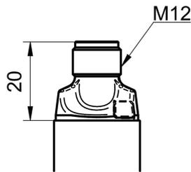
Steckverbindung M12-A, 4-Pin, Polycarbonat (mit LED)
